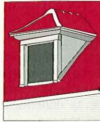
Lucarne à croupe sur versant de toiture
