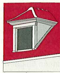
Lucarne à croupe sur versant de toiture
