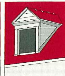
Lucarne à fronton sur versant de toiture
